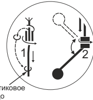
Установка балласта на поплавок
