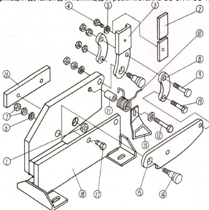
Перечень деталей для ножниц для резки металла SS-8N и SS-12N
