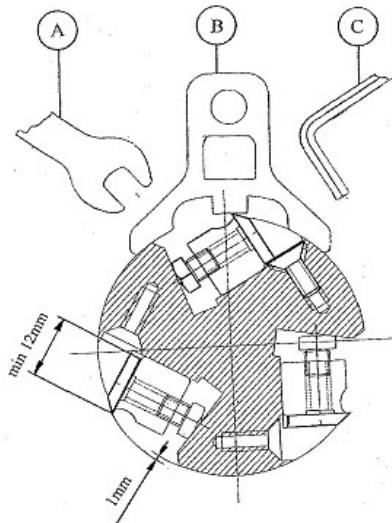
Для закрепления строгального ножа, выкрутите четырехгранные болты с прижимной планкой строгального ножа полностью. Сначала затяните оба внешних четырехгранных болта, затем оставшиеся. Инструмент для затягивания (а) не перегружать, не использовать удлинители для усилия рычага, не ударять. Установите кожух для приема стружки. Подключите вытяжную установку.
