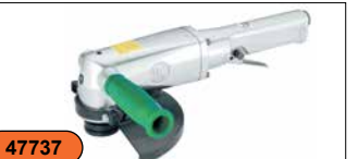
Пневматическая углошлифовальная машина 7", 7000 об./мин., 257 л/м
