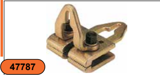
Зажим для кузовных работ, 2 направления, нагрузка: продольно - 5 т, поперечно - 3 т
