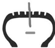
Неправильне встановлення джгута
