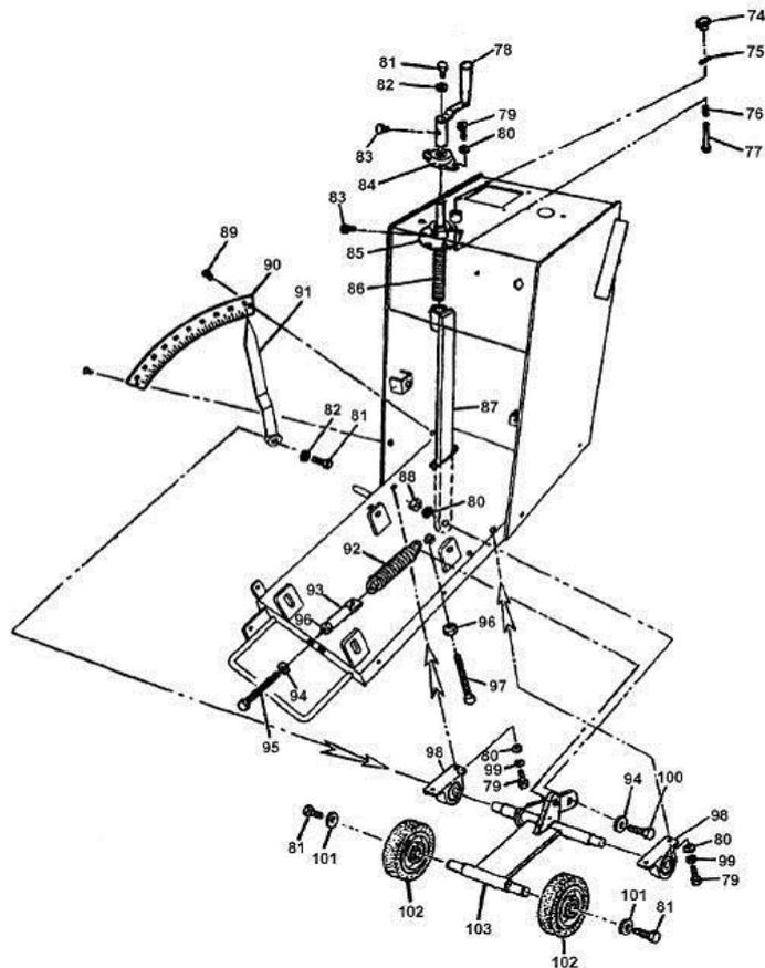
**МЕХАНИЗМ РЕГУЛИРОВКИ ГЛУБИНЫ****МЕХАНИЗМ РЕГУЛИРОВКИ ГЛУБИНЫ**
