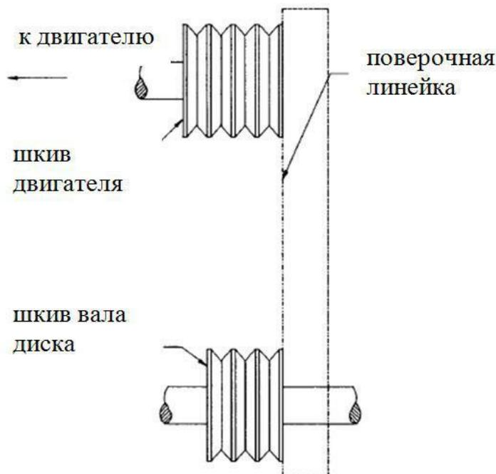
7. Приставьте поверочную линейку к внешней стороне обоих шкивов, как показано на рисунке. У всех шкивов по два (2) установочных винта на дне пазов. На установочные винты требуется нанести резьбовой герметик.
