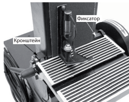
Рис. 6 Використовування столу зі стрічковим вузлом
