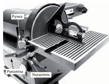
Рис. 5 Використовування столу з кругом
