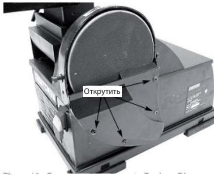
Рис. 14 Зняття кришки для заміни круга
