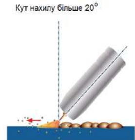
Велике розбризкування, поганий контроль зварювання та погане проплавлення, нестабільна дуга
