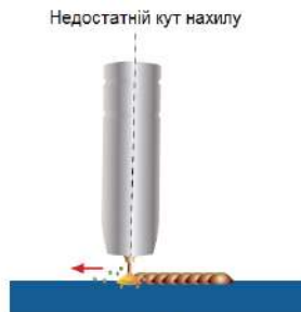
Збільшене розбризкування металу, погіршений контроль зварювання
